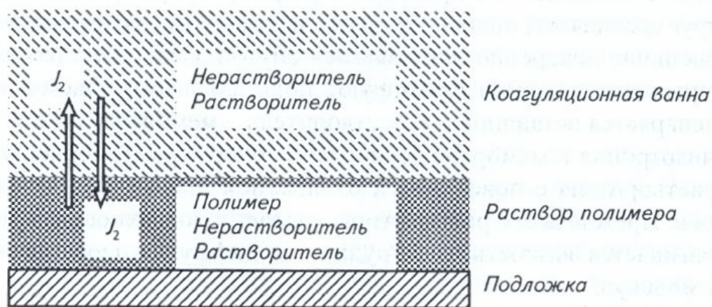
Рис. 8. Схема «мокрого способа» формирования мембран.
