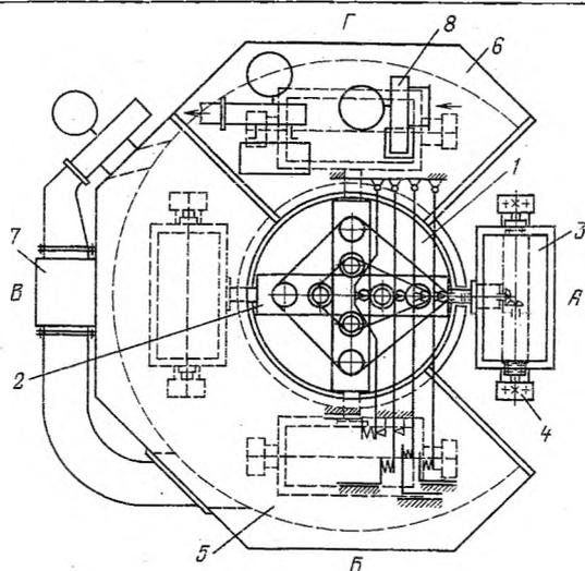
Схема роторной линии для ротационного формования. 1 — стол для поворота роторов; 2 — центрифуги для вращения роторов; 3 — форма; 4 — вилка формодержателя; 5 — двухсекционная камера нагрева; 6 — камера охлаждения; 7 — система нагрева воздуха; 8 — система охлаждения. А — позиция «загрузка — выгрузка»; Б, В — позиции «нагрев»; Г — позиция «охлаждение».
